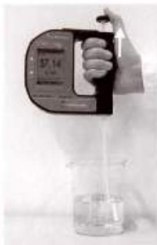
Abb. 9 - 2 Pumpenknopf loslassen und Ergebnis ablesen
