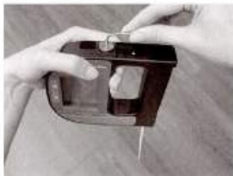
Abb. 11 - 3 Batterieverschluss entfernen
