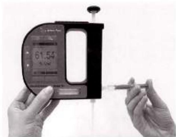
Abb. 9 - 3 Probe mithilfe einer Spritze einfüllen
