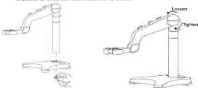
Après avoir réglé le bouton de tension jusqu'à un certain niveau, il est possible de déplacer le bras supérieur vers le haut et vers le bas. En plaçant l'électrode de pH sur le bras et en réalisant un étalonnage ou une mesure, il est possible de placer la bouteille de stockage de l'électrode de pH dans l'orifice de la base pour un rangement aisé :
