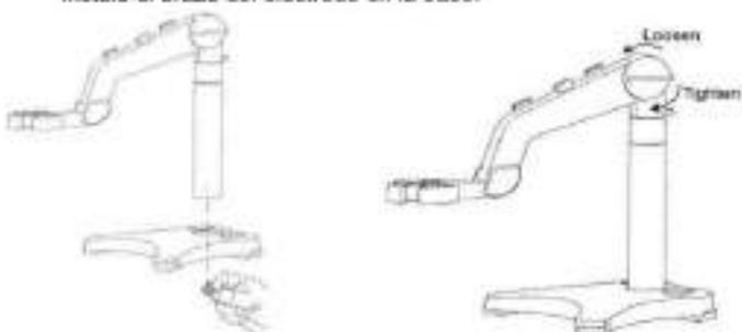
Después de ajustar la perilla de apriete hasta cierto punto, el brazo superior puede moverse hacia arriba y abajo. Cuando el electrodo de pH se coloca en el brazo y se realiza la calibración o medición, el frasco de almacenamiento del electrodo de pH puede colocarse en el orificio de la base para fácil almacenamiento:
