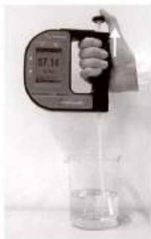
Abb. 9 - 2 Pumpenknopf loslassen und Ergebnis ablesen
