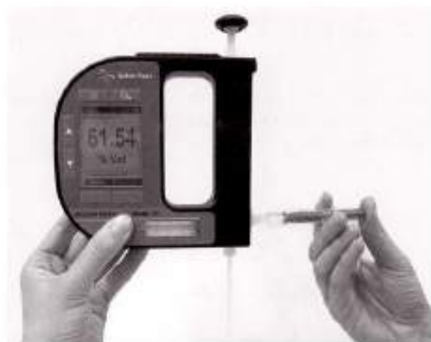
Abb. 9 - 3 Probe mithilfe einer Spritze einfüllen
