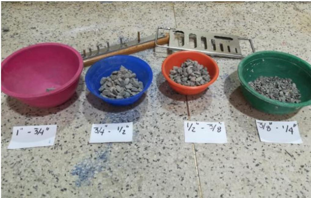
Figura 7 Tamizado de los agregados Fuente: propia [7].
