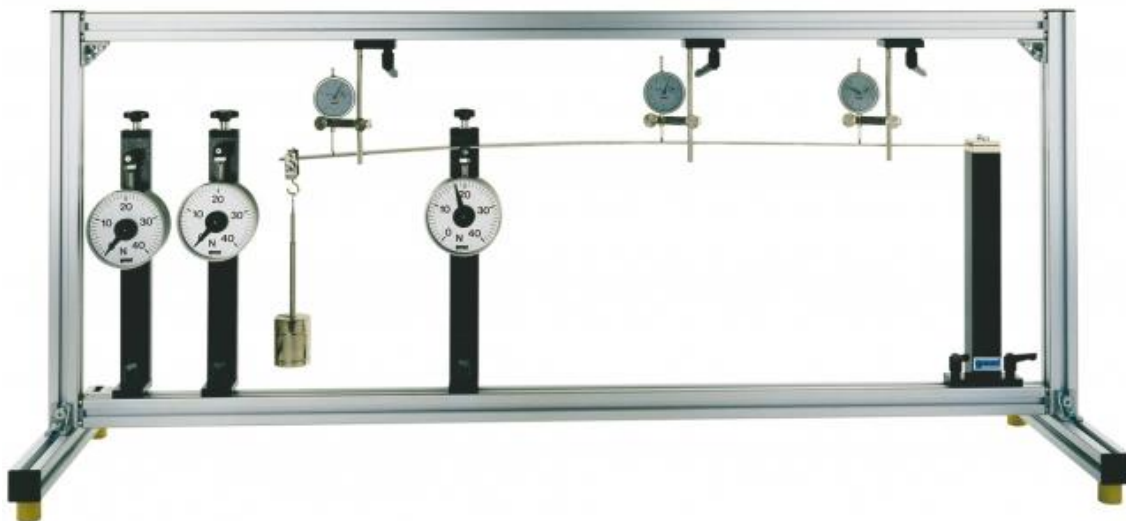
Ilustración 2. Equipo de deformación de vigas.
