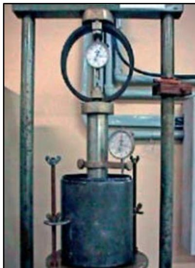
Figura 3. Ensayo de penetración
