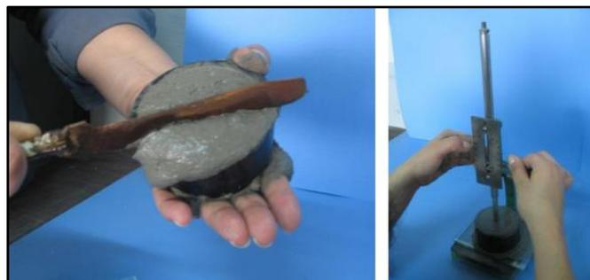
Figura 7. Colocación de la muestra en el aparato de Vicat [4].
