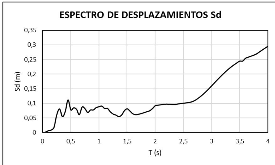
Ilustración 10. Ejemplo de espectro de desplazamientos,  $\xi = 5\%$ .
