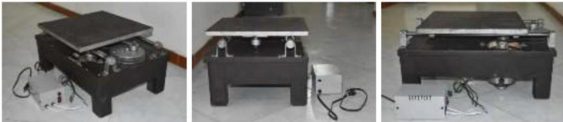
Ilustración 5. Mesa vibratoria unidireccional
