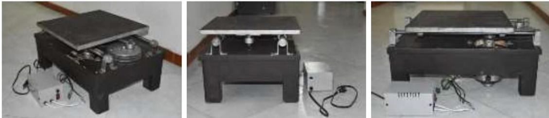
Ilustración 1. Mesa vibratoria unidireccional
