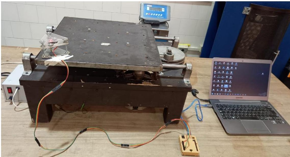
Ilustración 4. Montaje experimental para la obtención del espectro de respuesta para el análisis modal espectral.
