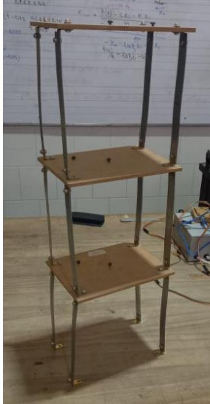
Ilustración 5. Modelo estructural, pórtico de tres niveles.
