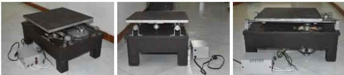
Ilustración 1. Mesa vibratoria unidireccional
