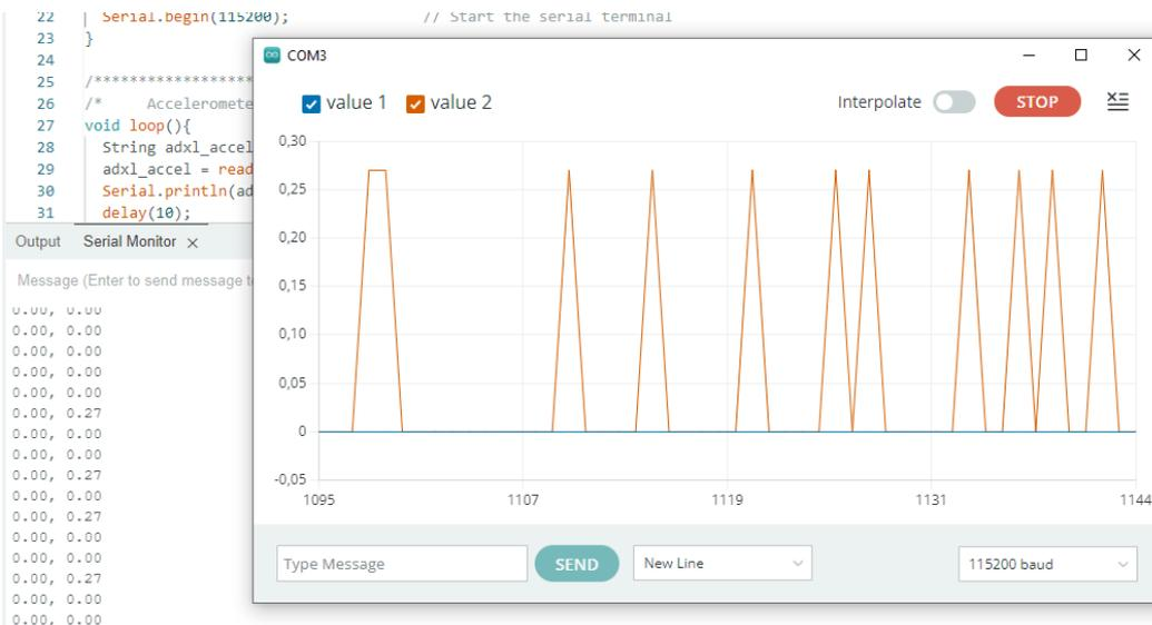
Ilustración 32. Chequeo calibración y funcionamiento acelerómetro de la base “COM3”.
