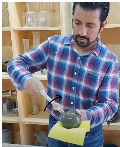
Figura 8. Proceso de eliminación de burbujas al interior del frasco [9].
