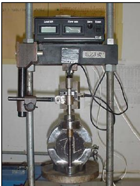
Figura 7. Aplicación de carga a la probeta Marshall. Fuente: INVIAS E-748-13
