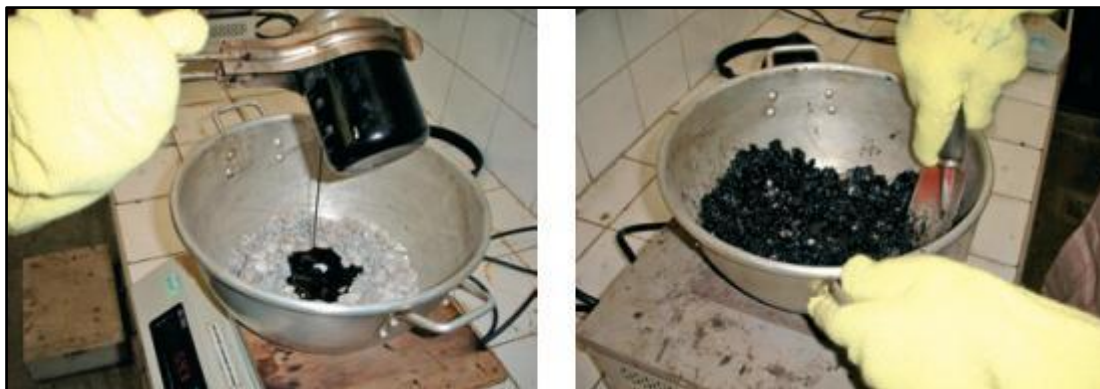
Figura 5. Adición del asfalto a los agregados y mezcla manual sobre una placa. Fuente: INVIAS E-748-13
