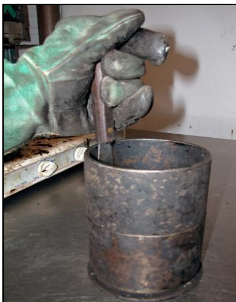
Figura 6. Golpes con la espátula a la mezcla dentro del molde. Fuente INVIAS E-748-13
