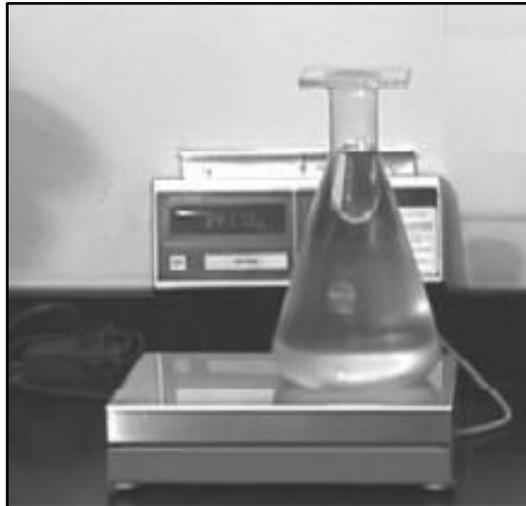
Figura 9. Placa de vidrio sobre el matraz lleno de agua. Fuente: INVIAS E-735-13
