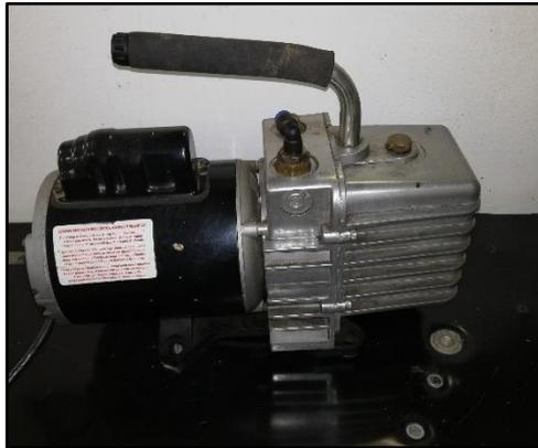
Figura 4. Bomba de vacío: Fuente propia
