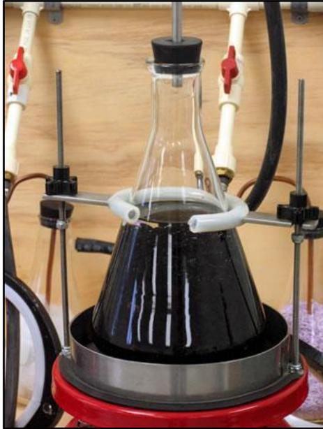
Figura 2. Matraz de vacío. Fuente: INVIAS E-735-13
