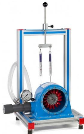
*Ilustración 2. Turbina Pelton FME16 marca EDIBON*
