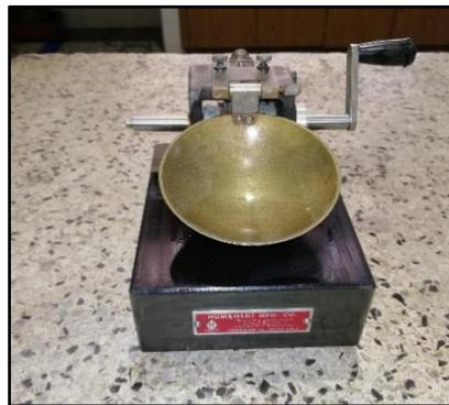
Figura 1. Aparato del límite líquido de operación manual. Fuente: Propia
