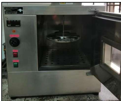
Figura 1. Horno para el ensayo de lámina asfáltica delgada
