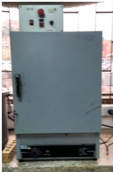
Imagen 1. Horno para secado de muestras. Fuente: Propia.
