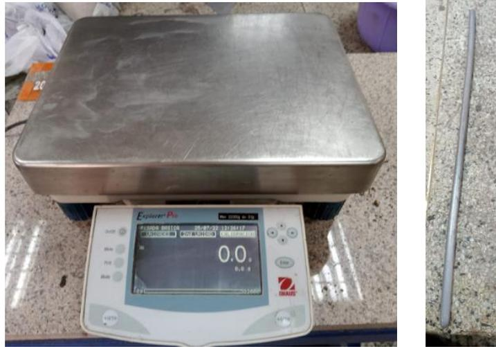
Ilustración 2 Balanza y varilla apisonadora
