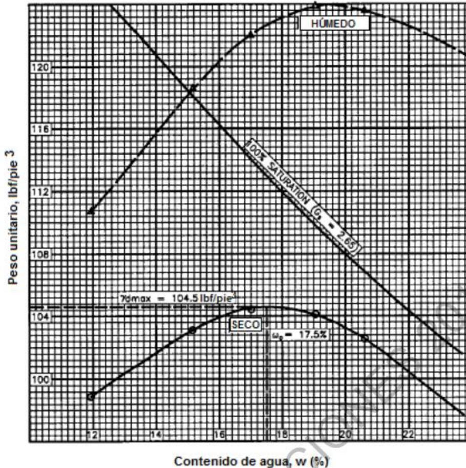
**Ilustración 3. Ejemplo de la curva de compactación. Fuente: Fuente: INV 141-13.**
