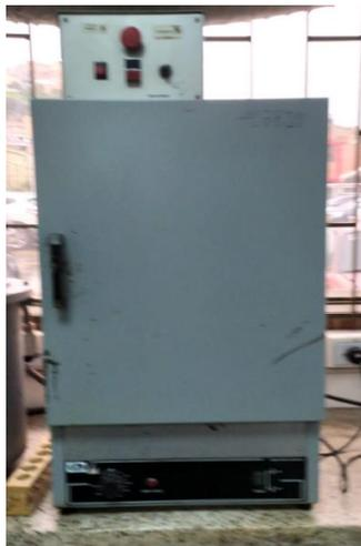
Imagen 7. Horno para secado de muestras. Fuente: Propia.
