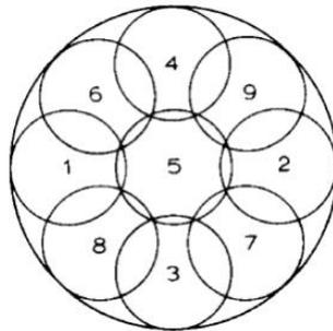
**Ilustración 2. Patrón de impactos para la compactación en el molde de 152.4 mm (6").**
