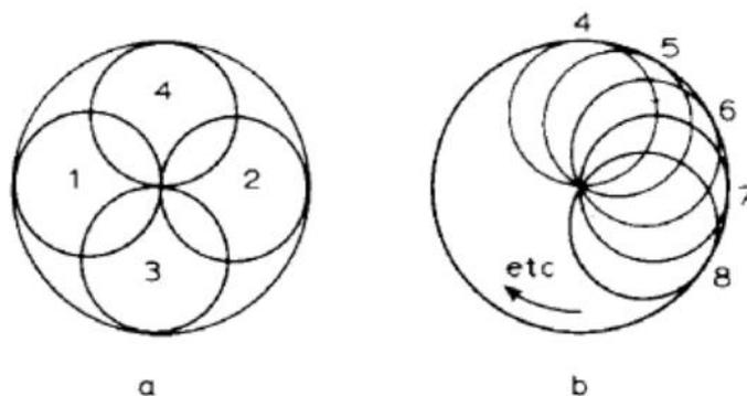
**Ilustración 1. Patrón de impactos para la compactación en el molde de 101.6 mm (4").**
