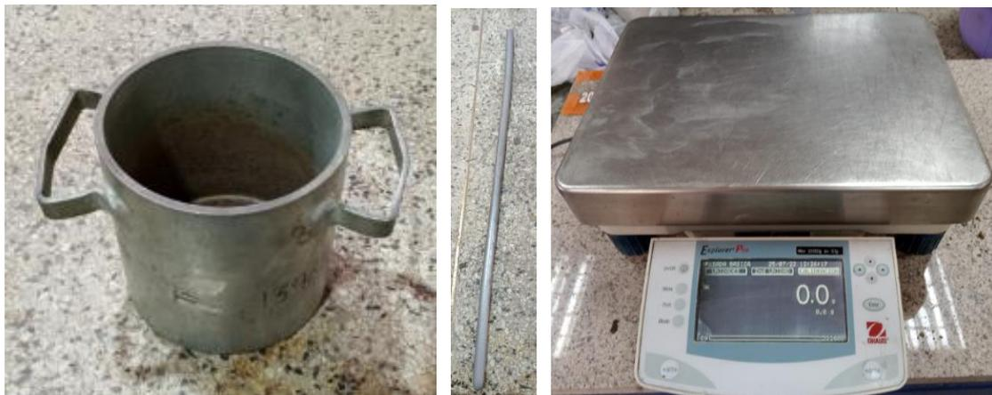
Ilustración 2 Ejemplo de recipiente, varilla apisonadora y balanza
