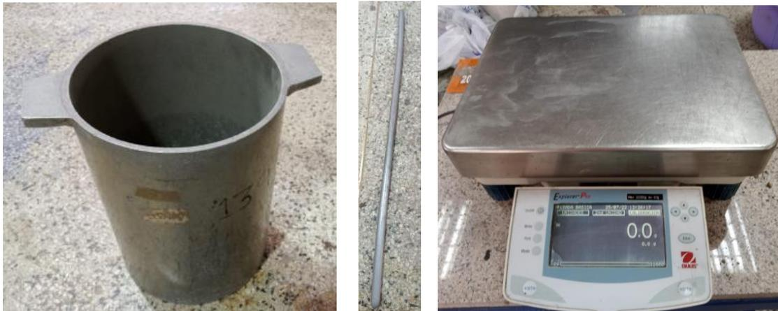
Ilustración 2 Detalle de elementos de recipiente, varilla compactadora y balanza.
