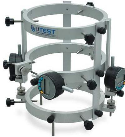
Ilustración 2. Compresómetro. Fuente: Utest
