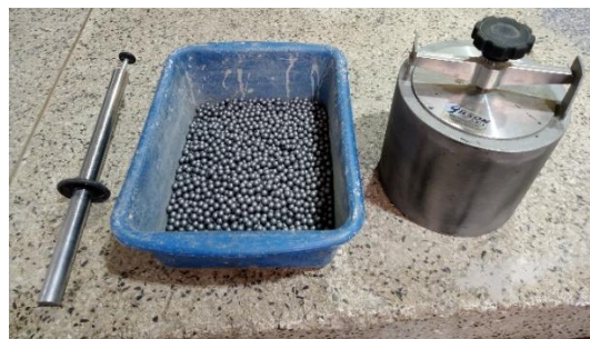
Ilustración 6 Recipiente junto a la carga abrasiva y el imán
