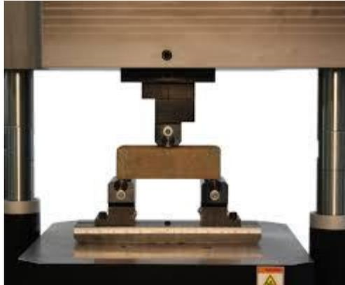
Figura 2. Máquina de ensayo módulo de rotura- resistencia a la flexión [2].
