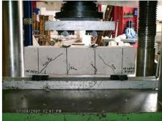
Figura 6. Medidas de viga y caracterización de fallas [6].
