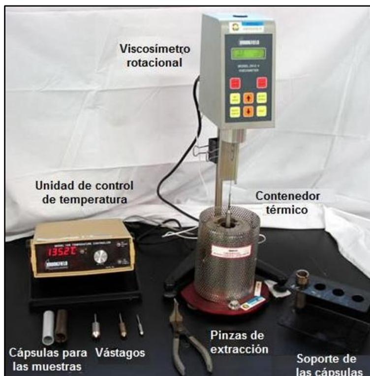
Figura 1. Elementos para determinar la viscosidad empleando el viscosímetro rotacional
