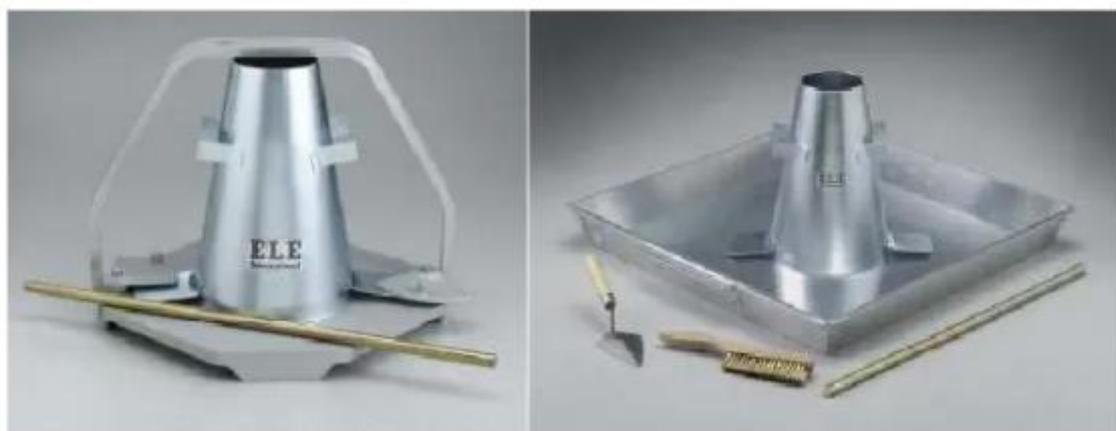
Figura 1. Cono de Abrams, varilla compactadora [1].
