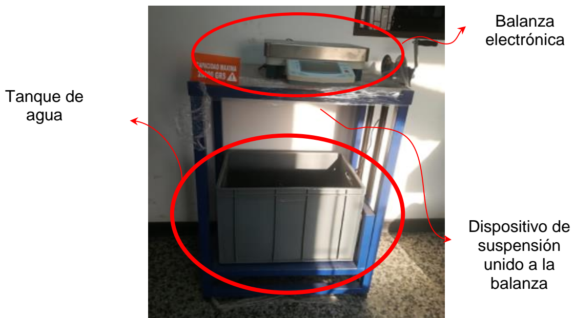
Figura 2. Balanza, tanque de agua, dispositivo de suspensión. Fuente: propia [2].
