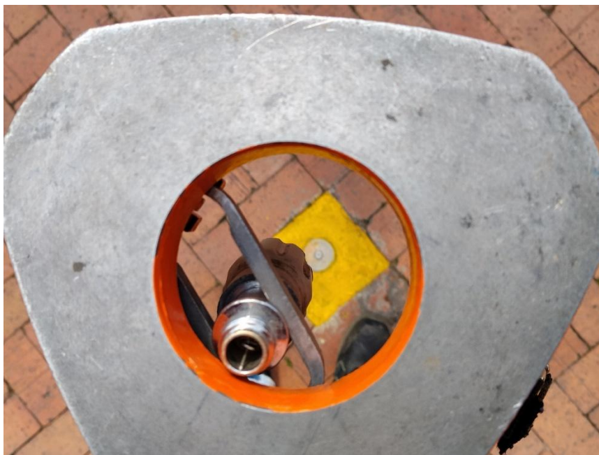
Figura 4. Verificación de punto de armado en el trípode. Fuente: Propia.
