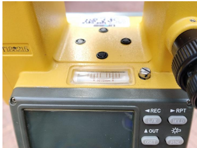
Figura 13. Nivel de línea después de la nivelación. Fuente: Propia.
