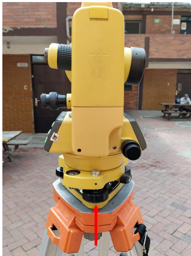
Figura 14. Giro de 90° para usar tornillo restante. Fuente: Propia.
