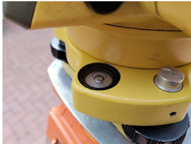
Figura 9. Equipo nivelado con las patas del trípode. Fuente: Propia.
