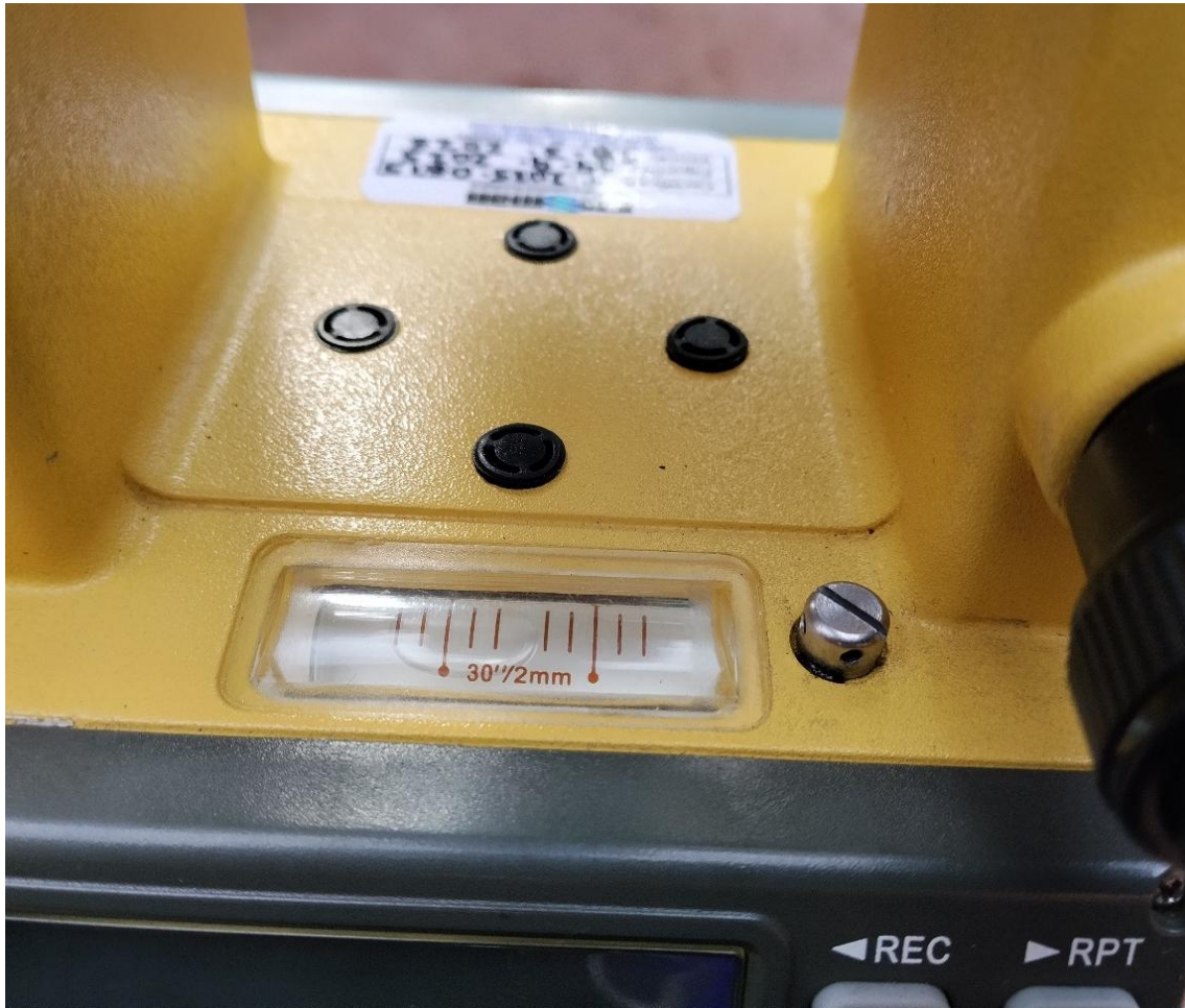
Figura 11. Equipo desnivelado. Fuente: Propia.
