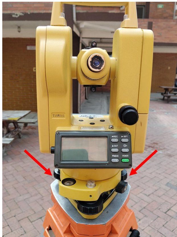
Figura 10. Giro del equipo con 2 tornillos de fijación en la parte posterior. Fuente: Propia.
