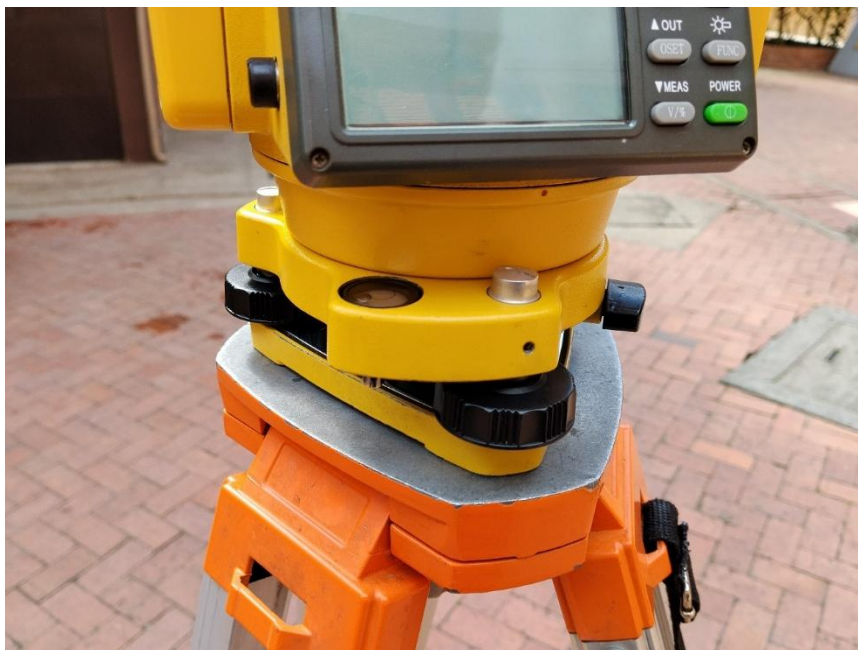
Figura 6. Colocación equipo en el trípode. Fuente: Propia.
