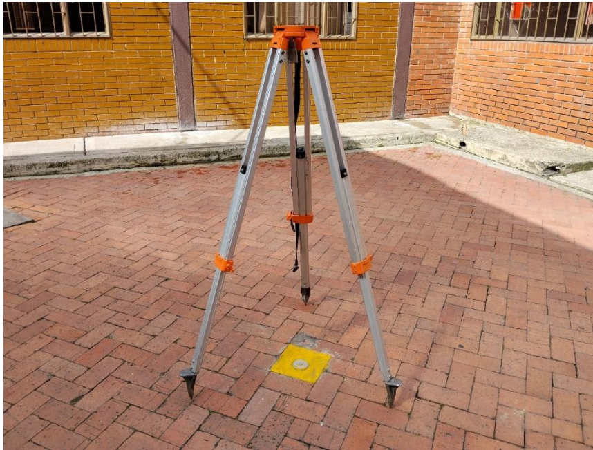
Figura 3. Elevación de trípode hasta altura de pecho del operario. Fuente: Propia.
