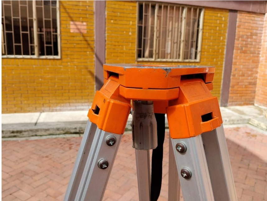
Figura 5. Plato del trípode nivelado. Fuente: Propia.
