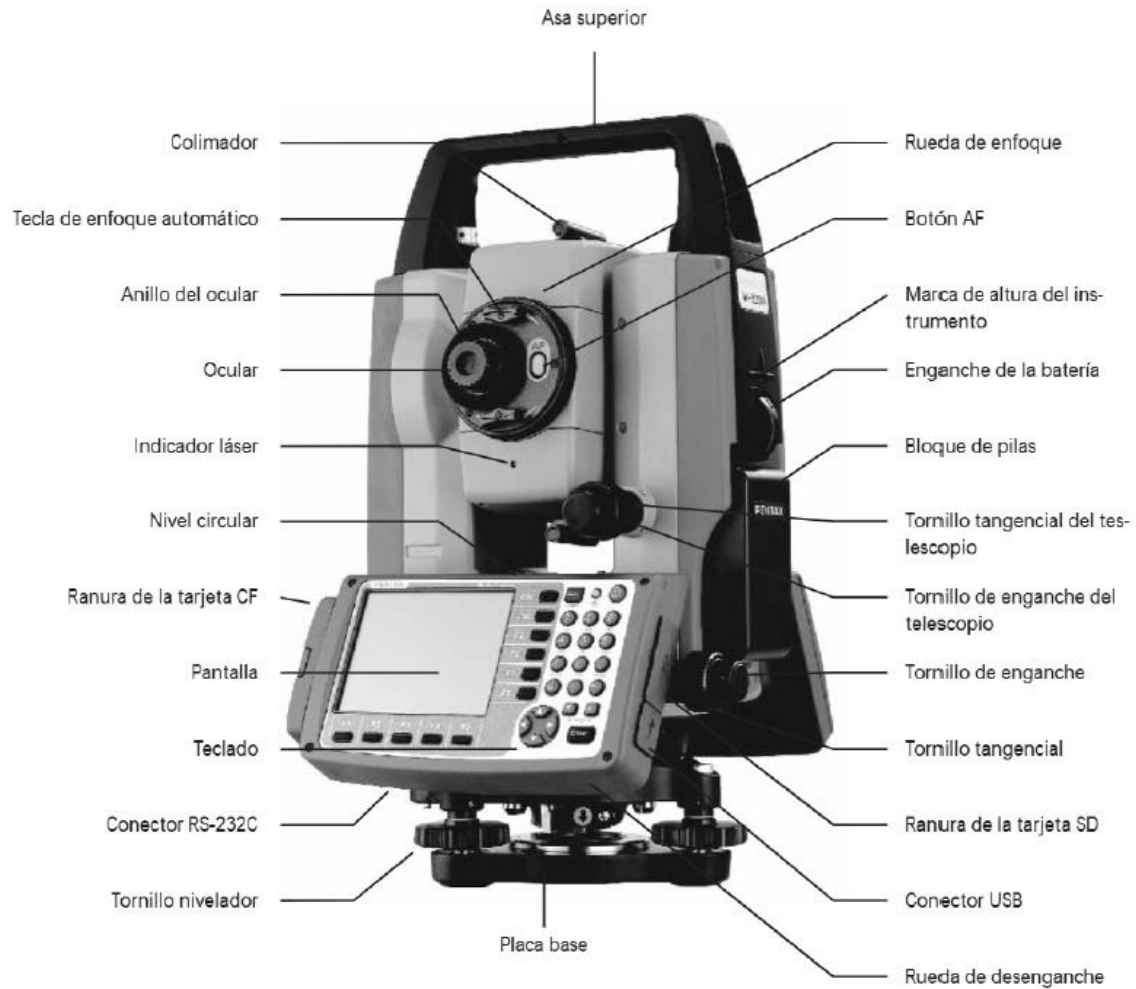
Imagen 1. Partes de la estación total. Fuente: PENTAX.
