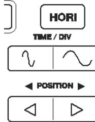
**1. BARRA DE POSICIÓN HORIZONTAL:** Se utiliza para controlar la posición de disparo contra el centro de la pantalla.
