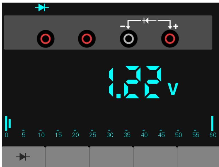
Figura 7-3 Medición de diodo
