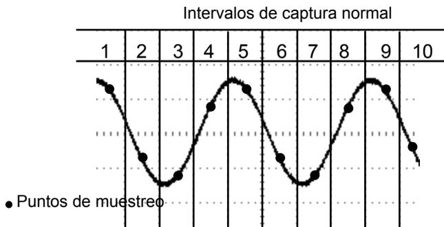
**Modo Normal** captura un punto de muestra singular en cada intervalo de forma de onda
