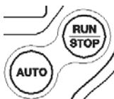
**AUTO:** Automáticamente ajuste los controles del osciloscopio para generar una imagen usable de las señales de entrada. Consulte la siguiente tabla para mayor información.
