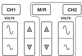
2. **Menú (CH1, CH2):** Muestra las opciones de menú vertical; activar (ON) o desactivar (OFF) la visualización de formas de onda de canal. Presione el botón **MENU** para activar el menú. Presione el botón CH1 ó CH2 para seleccionar el canal que quiere ajustar. Presione el tecla F5 para cambiar la página 1 del menú a la página 2.
