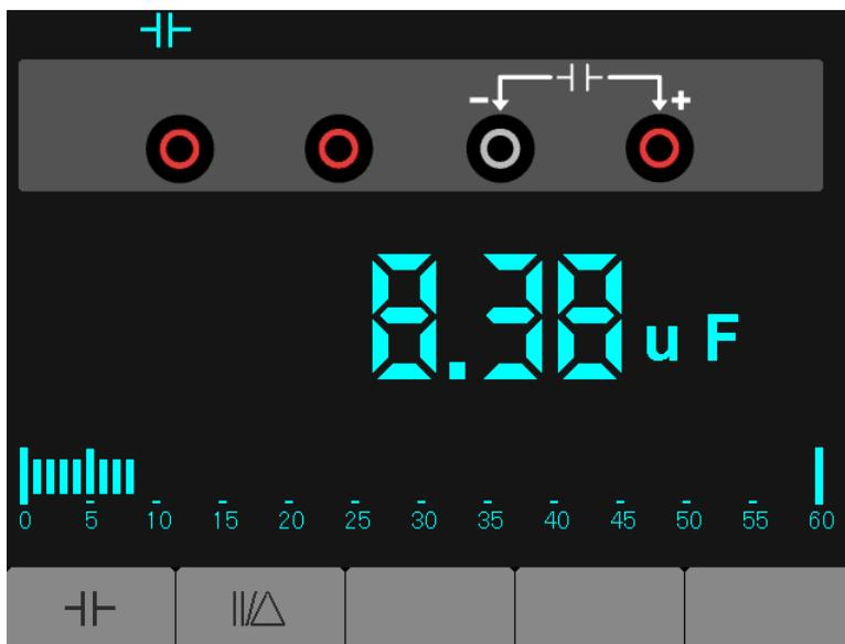
Figura 7-5 Medición de capacitancia
