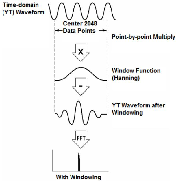
**Selección Ventana FFT:** La función matemática FFT tiene cinco opciones de ventana FFT. Existe una compensación entre la resolución de la frecuencia, la dispersión espectral y precisión de la amplitud para cada tipo de las opciones de la ventana. Determine cuál elegir de acuerdo al objeto que se desea medir y las características de la señal de origen.
