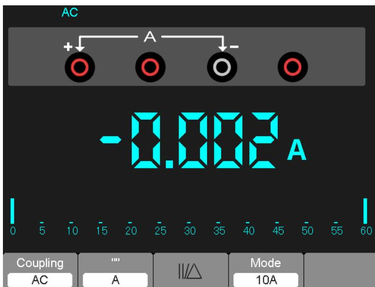
Figura 7-11 Medición de corriente CA para 10A
