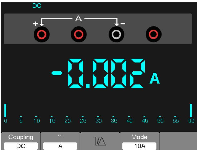
Figura 7-9 Medición de corriente CD para 10A
