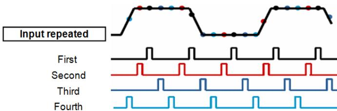
Como se indica previamente, capture una señal de entrada repetible. Muestree la señal en varios intervalos. Guarde los valores digitales en la memoria. Los puntos de muestreo se pueden usar ahora para recrear la forma de onda.
