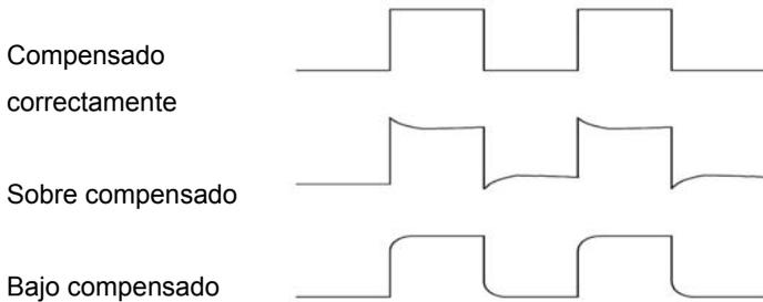
3. Si es necesario, use un destornillador no metálico para ajustar el capacitor variable del sensor hasta que la forma de la forma de onda se parezca a la que se muestra arriba en la imagen. Repita este paso como sea necesario para sondas adicionales. Consulte la siguiente imagen que ilustra el ajuste.
