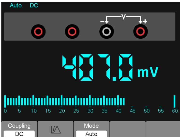
Figura 7-6 Medición de voltaje CD
