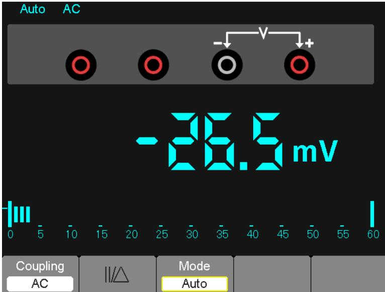
Figura 7-7 Medición de voltaje CA
