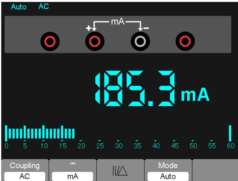
Figura 7-10 Medición de corriente CA para 600 mA
