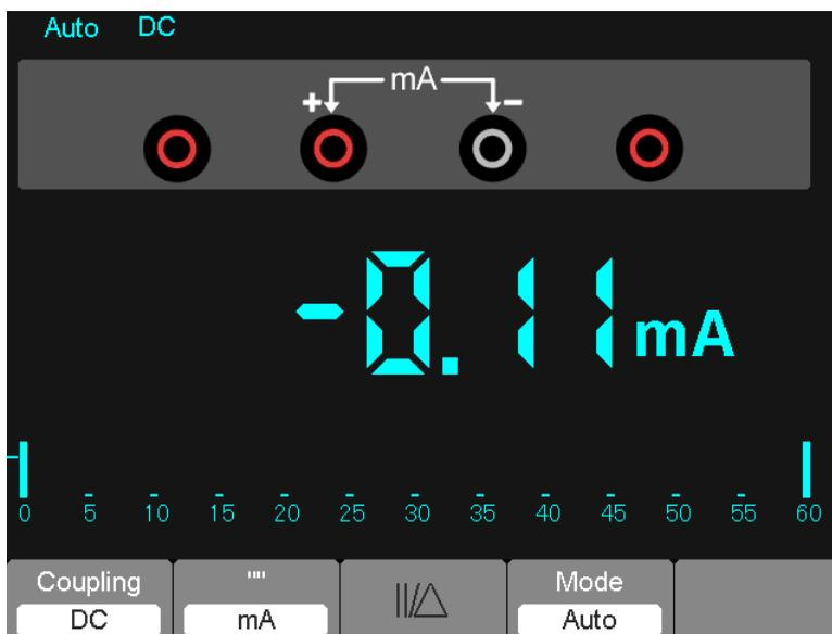
Figura 7-8 Medición de corriente CD para 600 mA
