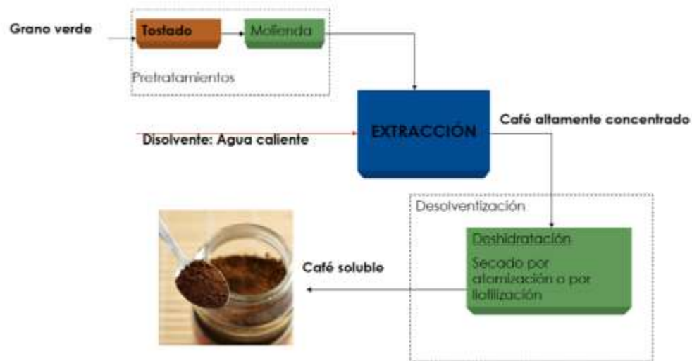
Figura 2. Proceso de obtención de café soluble
